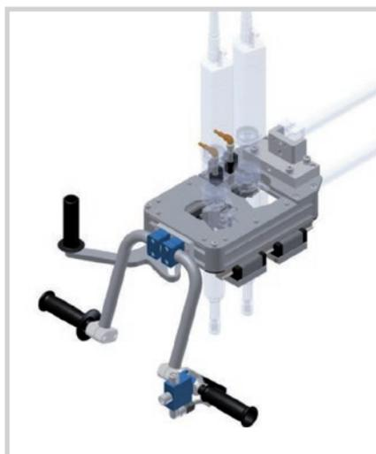
Vissage bi-broches avec entre-axe variable
