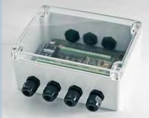
Das digitale I/O-Modul bezieht seine Spannung von der EXAConnect Steuerung und empfängt Schraubdaten über die RS-422-Schnittstelle der Steuerung. Das Modul hat jeweils 16 Ein- und Ausgänge für den Datenaustausch mit einer SPS. Die Konfiguration erfolgt über die EXAConnect Software (in einem Web Browser).
