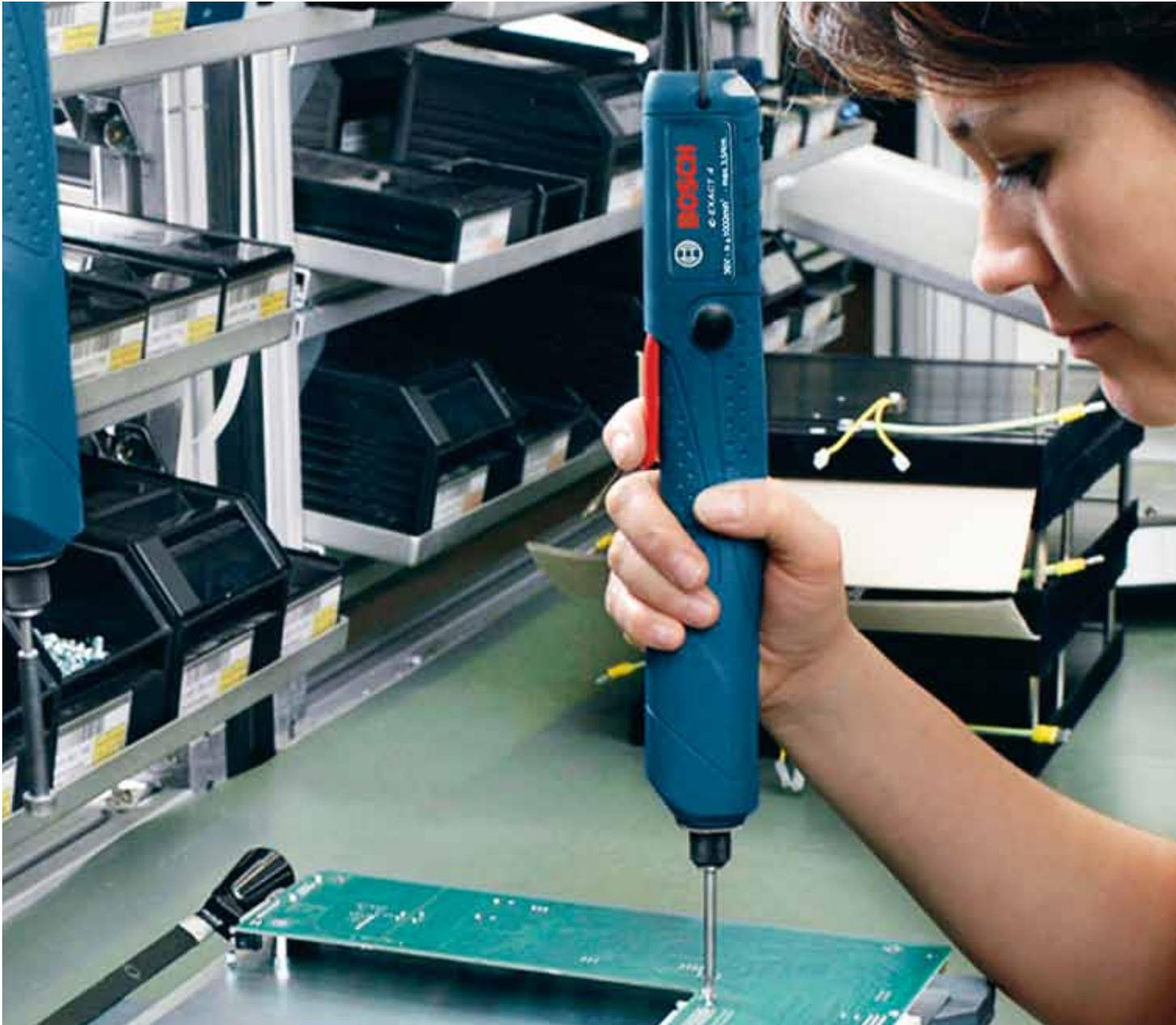
Durch die elektrische Entladungsfähigkeit ist das Schraubsystem ideal für den Einsatz in der Elektronik- und Elektroindustrie.
