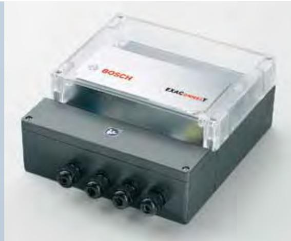
Die Steuerung EXAConnect ist das Bindeglied zwischen Ihrem Prozessnetzwerk und dem über Bluetooth angebotenen BT-EXACT Akkuschauber. Informationen über den Verschraubungsprozess können bidirektional in Echtzeit ausgetauscht werden, um sicherzustellen, dass jeder BT-EXACT Akkuschauber genau weiß, was er wann zu tun hat. Eine EXAConnect Steuerung kann sieben BT-EXACT Schrauber gleichzeitig steuern und ist damit im Vergleich zu anderen Systemen sehr kostengünstig.
